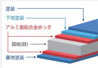
屋根壁は亜鉛、アルミ、シリコンのめっきを施したガルバリウム鋼板。錆に強く耐久性も◎
